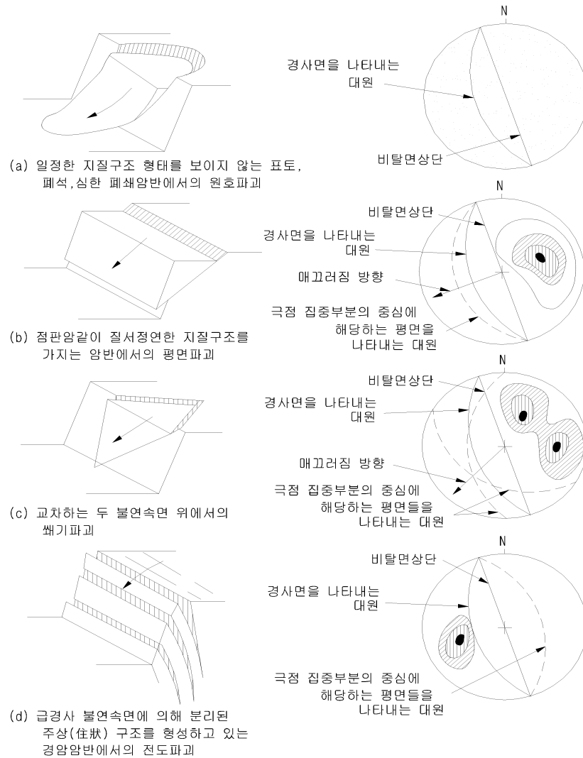
[그림 14.7] 절토사면의 파괴 유형과 평사투영해석
